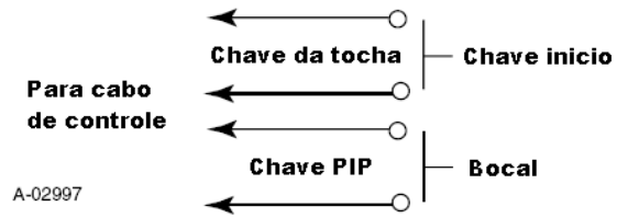
Diagrama do circuito de Peça no Local da tocha manual
